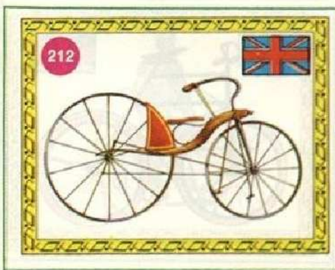
Macmillan: draisina a leve Inghilterra 1838 Veniva azionata da lunghe leve collegate con la ruota posteriore mediante un palo di bielle.
