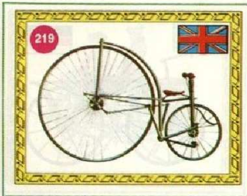
219 Lawson: biciclo a leve Inghilterra 1876 Veicolo con ruota anteriore più piccola della posteriore e trasmissione a leve articolate funzionanti nel mozzo mediante un meccanismo a rocchetto.
