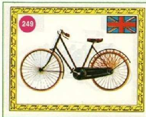
Brown: bicietletta da donna Inghilterra 1896 Modello con telaio rinforzato, freno a leva, parafanghi, copricatena, copri ruota.
