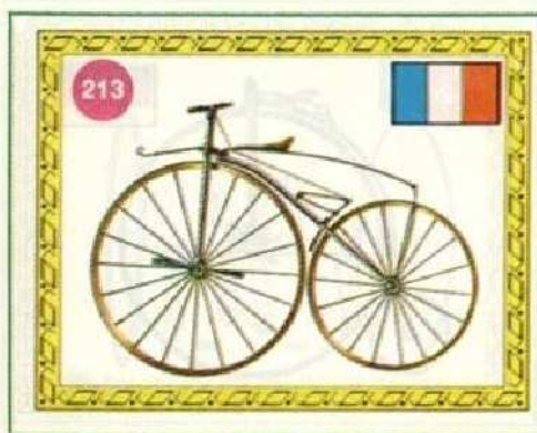
Michaux: draisina a pedali Francia 1855 Detta anche «Michaudina», i pedali erano applicati direttamente alla ruota anteriore.
