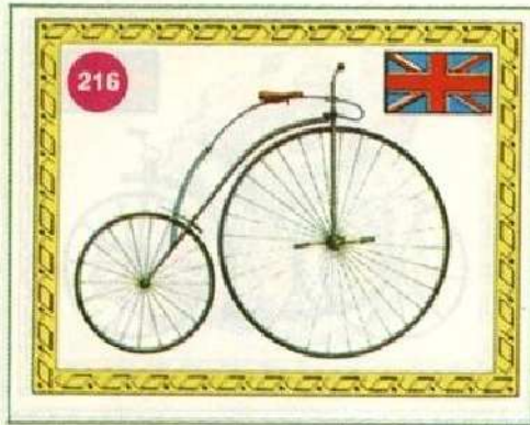
216 Hanton: biciclo a pedali Inghilterra 1869 Veicolo con ruota anteriore notevolmente più grande di quella posteriore: si aumentava così la velocità, ma anche la possibilità di cadute in avanti.
