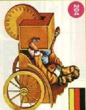
204 Germania 1655 Farler: veicolo a tre ruote Veniva mosso in moto da un meccanismo composto da una ruota dentata che agiva sulla ruota anteriore, mosso a braccia.
