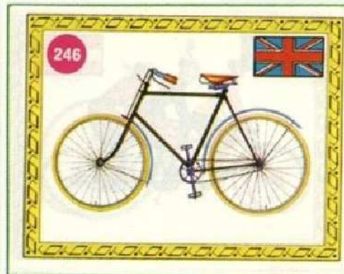
Humber: bicietletta da turismo Inghilterra 1893 Modello munito di sella ammortizzata, freno a leva, trasmissione a catena, gomme pneumatiche tubolari, parafanghi.
