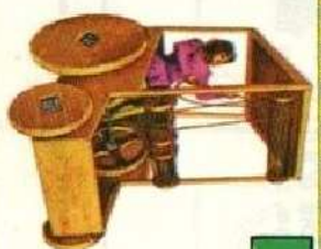
203 Italia 1420 Fontana: veicolo a braccia Veicolo a quattro ruote azionato da un meccanismo a ingranaggi mosso a braccia.
