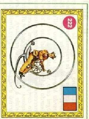
222 Rouseau: monociclo Veicolo a contrappeso, composto di due cerchi concentrici a tre ruote che giravano in una rotella interna del cerchio minore.
