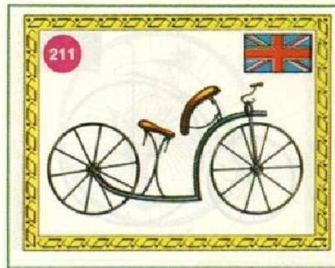
Johnson: draisina da donna Inghilterra 1819 In ferro, con telaio sagomato in basso perché la lunga gonna della dama non fosse di impedimento.
