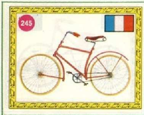
Mercier: bicietletta da turismo Francia 1893 Veicolo con telaio munito di sospensioni elastiche, trasmissione a catena, gomme tubolari pneumatiche.
