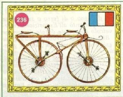
Michaux: dupletta Francia 1868 Tutta in legno, con telaio a trave, ruote uguali, pedali indipendenti. Pesava settanta chilogrammi.
