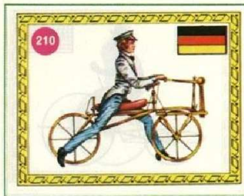
Von Drais: draisina da turismo Germania 1820 Era dotata di portabagagli sulla ruota anteriore e di sedile mobile per essere adattato all'altezza del conduttore.
