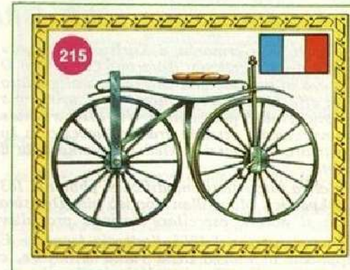
215 Lefèvre: biciclo a pedali Francia 1867 Presentato all'Esposizione Universale di Parigi; era munito di pedivelle allungate, ruote cerchiare di ferro e sella a sospensione elastica.
