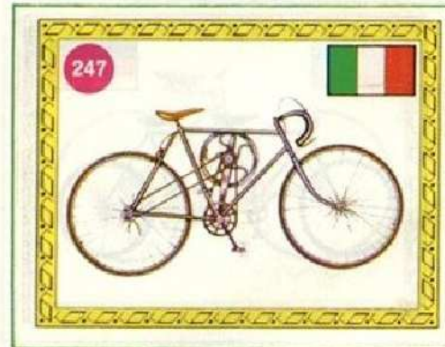
Anonimo: bicietletta a volano Italia 1896 Veicolo con trasmissione a volano e a ingranaggi che agivano sul mozzo della ruota posteriore; la forcella anteriore era munita di sospensioni.
