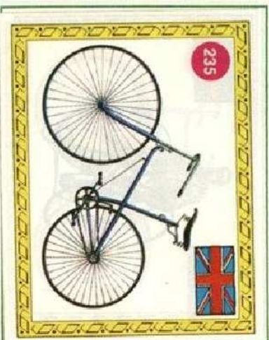
235 Inghilterra 1886 Ivel: bicicletto da corsa Telaio rinforzato e rigido, sella ammortizzata, manubrio ricurvo e moltiplica maggiorata.
