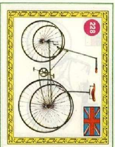
228 Quaker: quadriciclo Veicolo ad un posto, con trasmissione motrice a catena. Trovò larga diffusione in tutta la Gran Bretagna.
