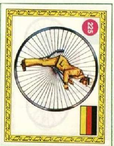
225 Leske: monociclo Veniva azionato a braccia mediante due leve fissate nell'asse della ruota a mezzo di un meccanismo a cricco fissato nel mozzo.
