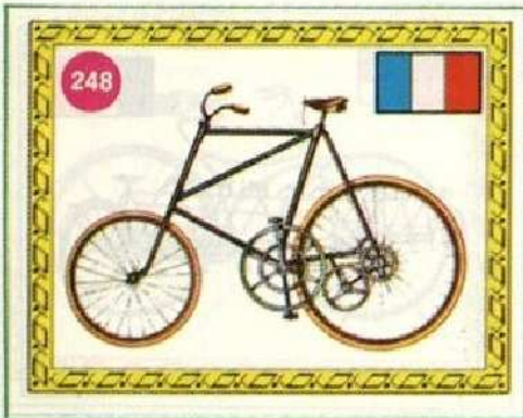
D'Ollières: bicietletta a ingranaggi Francia 1899 Trasmissione a tre ingranaggi, telaio rinforzato, ruota anteriore più piccola della posteriore.
