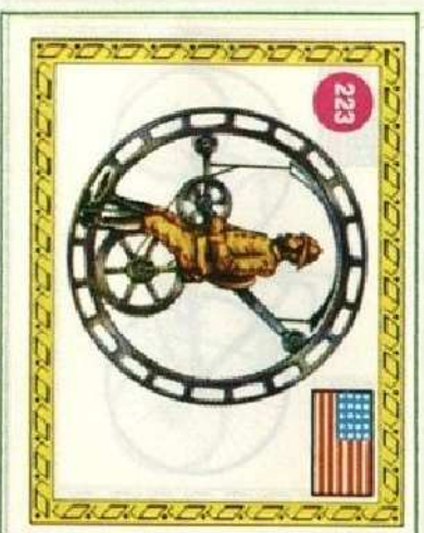
223 Hemming: monociclo Veniva azionato con le braccia, che agivano su ingranaggi a manovella collegati col mozzo di una ruota dentata motrice.
