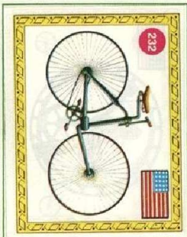
232 Latza: bicicletto Telaio con telaio a triangolo e manubrio rigido; veniva guidato col movimento del corpo e si poteva chiudere a libro. America del Nord 1888
