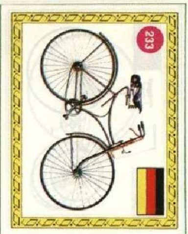
233 Germania, 1868 Erculei: bicicletto da turismo Telaio a tubi ricurvi, sella munita di sospensioni elastiche, freno a leva, trasmissione a catena, parafranghi.
