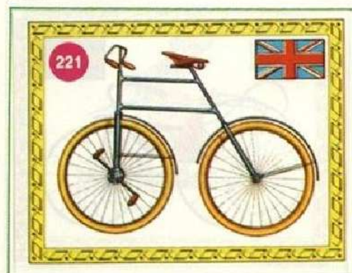
221 Batam: biciclo a ingranaggi Inghilterra 1890 Completamente in ferro, con telaio aerodinamico e trasmissione a ingranaggi sulla ruota anteriore motrice.
