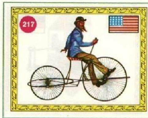
217 Mac Donald: biciclo a pedali America del N. 1869 Veicolo con telaio orizzontale, munito di cerchio che impediva le cadute in avanti, e guida a leva collegata con la ruota posteriore.
